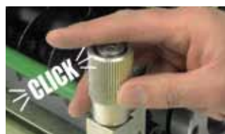
Každým otočením nastavovacího prvku o čtvrt otáčky snižíte výšku seče o 0,25 mm.
