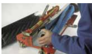
Stačí vyklopit ochranný kryt, vyměnit kazetu a zavřít ochranný kryt.
